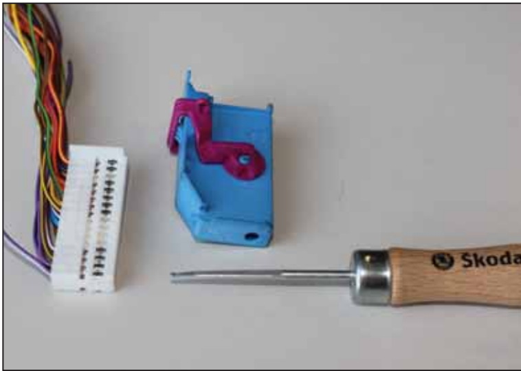
e) Herausnahme der Klemmleiste mit Verbindungssteckern nach Lösung der sekundären Sicherung (Anschlag)
