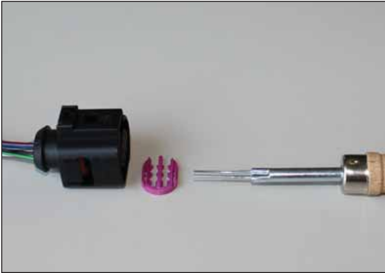
d) Lösung der sekundären Sicherung
