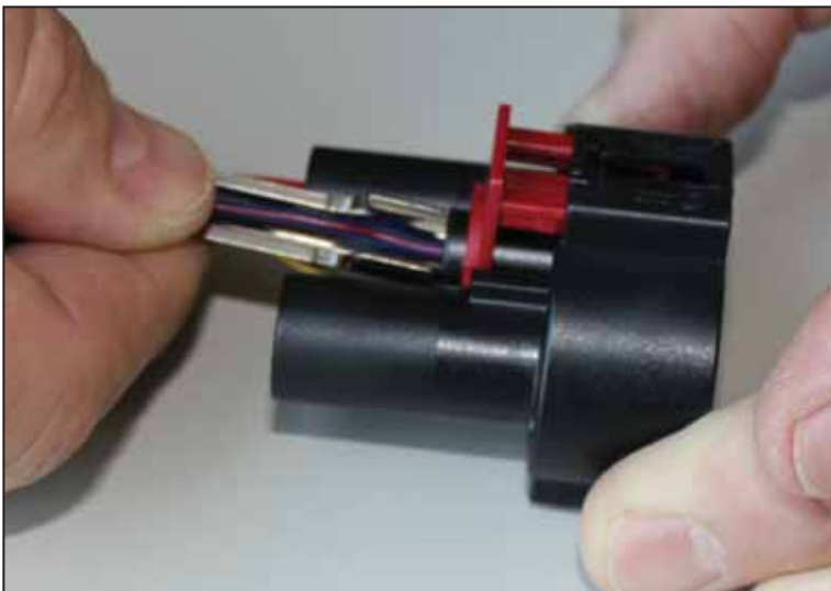
Andrücken der Dichtung in die Klemmleiste (auf Anschlag)
