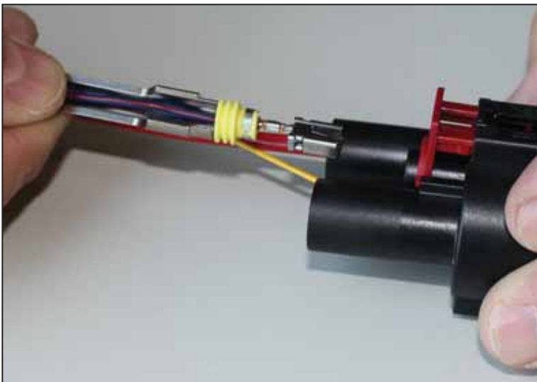
Einlegen des Leiters mit Dichtung in die Montagevorrichtung
